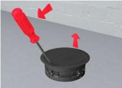
Mittelteil des Leitungsauslasses LAFK G20, für Bodenstärke von größer 20 mm, wird mit einem Schraubendreher ausgehebelt und nach oben herausgenommen.
