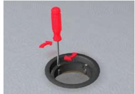
4 Befestigungsschrauben andrehen. Dadurch wird der Befestigungsring ähnlich wie bei Dübeln nach außen auseinandergespreizt und befestigt somit den Leitungsauslass LAFK G20 in der Einbauöffnung.
