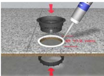
Leitungsauslass LATU K20 wird von oben in die Einbauöffnung eingesetzt und mit geeignetem Dichtmaterial eingeklebt. Die Einbauöffnung hat einen Durchmesser von 112 mm. Befestigungsring (Mutter) wird von unten angeführt.
