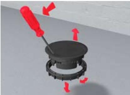
Mittelteil des Leitungsauslasses LAFK K20, für Bodenstärke von kleiner 20 mm, wird mit einem Schraubendreher ausgehebelt und nach oben herausgenommen. Befestigungsring (Mutter) wird abgeschraubt und nach unten entnommen.
