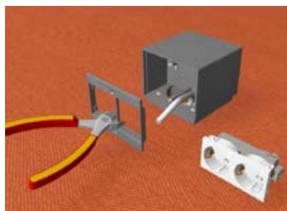
Bei Verwendung von 2-fach Schutzkontakt-Steckdosen muss der Mittelsteg der Installationswand mit einem Seitenschneider entfernt werden.
