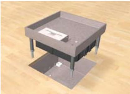
Kassette von oben in die Einbauöffnung einsetzen. Nivellierstifte in die Dämmlager der UDS-ZuHause eindrücken.
