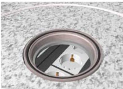
Nach dem Herausrauben des Tubus-Deckels überprüfen, ob sich die Gummidichtung im Tubus-Montagesatz befindet und nicht fälschlicherweise am Tubus-Deckel haftet. Die Gummidichtung sollte in regelmäßigen Abständen mit Vaseline eingeschmiert werden.
