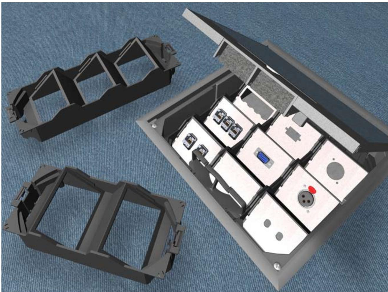
Einfache Montage. Die Montageplatten werden von oben in eine Halterung eingesteckt und durch einen Rastmechanismus befestigt.
