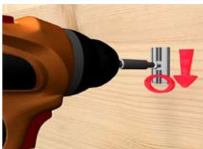
Wandhalter mit einer Schraube an seitlicher Wand befestigen. Wandhalter muss so angebracht werden, das die Führungsnut unten geschlossen ist.
