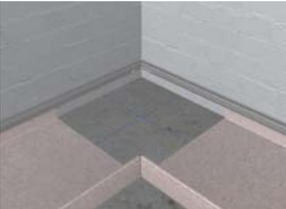
Kanalunterteile im Winkel stumpf aneinander legen. Seitenprofil (lang) auf Gehrung sägen und mit Winkelverbinder verschrauben.
