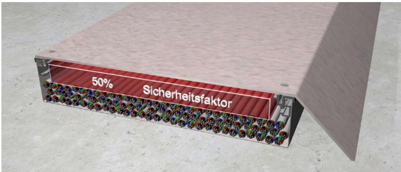
Um die richtige Kanalgröße zu definieren, wird das Kabelvolumen benötigt. Da die Kabel in der Praxis nie optimal parallel und platz sparend nebeneinander liegen, rechnet man hier mit der Formel  $(d)^2$  Durchmesser zum Quadrat.
