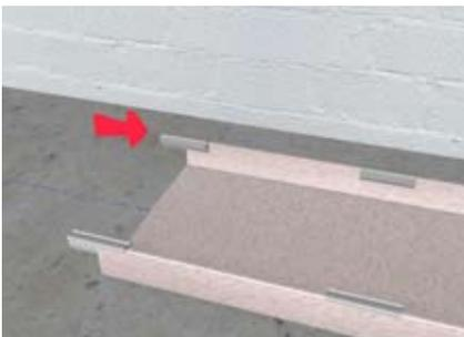
Bei Kanalunterteilen AUS ... K0 (für beidseitig abgekantete Blinddeckel), werden auch auf den hinteren, zur Wand gerichteten Schenkel, Seitenprofile (kurz) verwendet.
