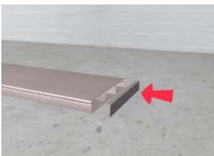
Endet der Unterflurkanal mitten im Raum, muss die Schnittkante durch Einschieben einer Endlasche geschlossen werden. Es ist kein Verschrauben nötig.
