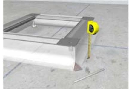
Nivellierbereich auf der Rohdecke überprüfen. Falls erforderlich, können die Gewindestifte bei Zug- und Abzweigdose UDB... oder UDH... gewechselt werden. Nur durch Drehen gegen den Uhrzeigersinn vom Dämmlager trennen. Nicht herausreißen oder hineinschlagen.
