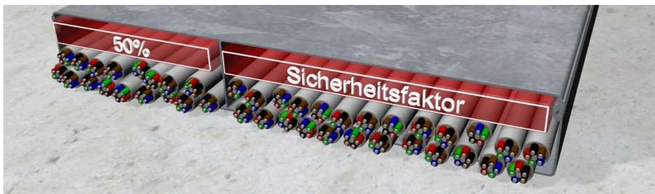
Um die richtige Kanalgröße zu definieren, wird das Kabelvolumen benötigt. Da die Kabel in der Praxis nie optimal parallel und platz sparend nebeneinander liegen, rechnet man hier mit der Formel  $(d)^2$  Durchmesser zum Quadrat.
