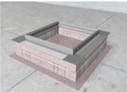
Bei einer Estrichhöhe von über 120 mm bei der Zug- und Abzweigdose UDS3 kann ein Aufstockrahmen UDA3 die Höhe der Zug- und Abzweigdose um 35 mm erhöhen. Dazu Aufstockrahmen auf Dosenrahmen setzen und viermal verschrauben.
