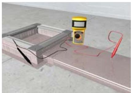
Durch Anpressen des Kanals auf dem Bodenblech mittels Bügel wird die Zug- und Abzweigdose mit dem Kanal elektrisch leitend verbunden. Die Kontaktflächen müssen sauber und fettfrei sein. Das Schutzleiterkabel in der Dose muss bauseitig in die Erdungsmaßnahme einbezogen werden.
