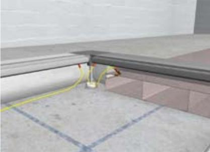
Das in der Zug- und Abzweigdose befindliche Schutzleiterkabel auf das zuführende Kanalende aufschlagen um somit die Zug- und Abzweigdose mit dem Kanal elektrisch leitend zu verbinden. Das Schutzleiterkabel in der Dose muss bauseitig in die Erdungsmaßnahme einbezogen werden.
