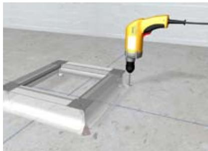
Bei der Zug- und Abzweigdose UDH... alle vier Haltepratzen an der Rohdecke andübeln. Bohrungen 1 x 6 mm und 1 x 7 mm sind jeweils an jeder Haltepratze vorhanden.
